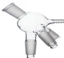
Utilizados en procesos de destilación fraccionada
